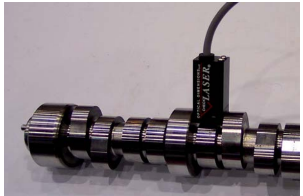
Model 8826 Lasercheck huvud mäter ytstruktur mellan lobber på kamaxel
